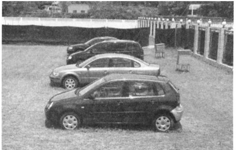
图7 整车自然暴露试验
